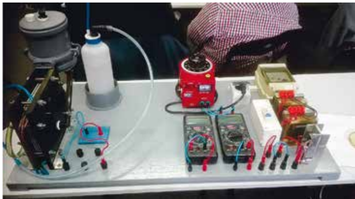
Praca modelowo-konstrukcyjna (I miejsce w kategorii Pierwsze Kroki) Stanowisko laboratoryjne do badań nad modelem elektrolizera zrealizowana przez Igora Architektę, Jakuba Gandziarskiego, Damiana Gasika i Piotra Mistrzaka, uczniów klasy II Toe Zespołu Szkół Ponadgimnazjalnych nr 20 w Łodzi (opiekun: mgr inż. Damian Mikołajczyk)
