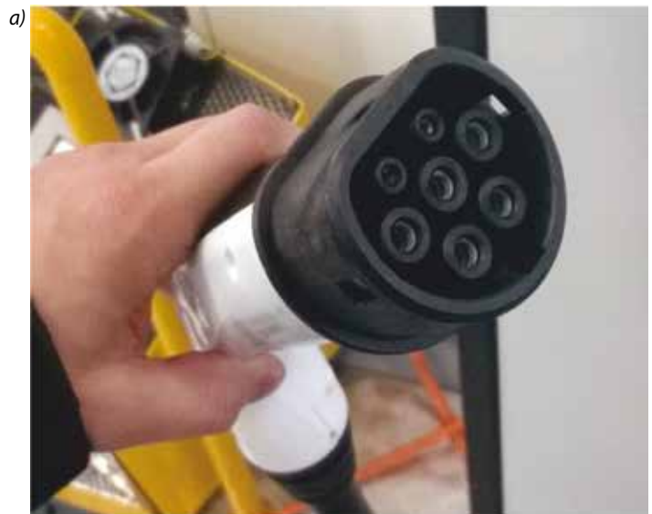
Rys. 4. Tryb ładowania 3, zgodnie z o IEC 61851 – 1 samochód może być ładowany tylko z dedykowanego punktu ładowania (EVSE) [8]
