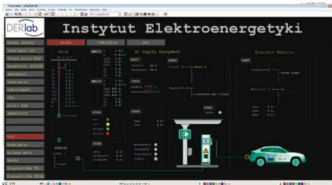
Rys. 8. Stanowisko operatorskie BTC Prins do dwukierunkowego sterowania mocą czynną i bierną ładowarki samochodowej. System zaimplementowano w Laboratorium Generacji Rozproszonej Politechniki Łódzkiej
