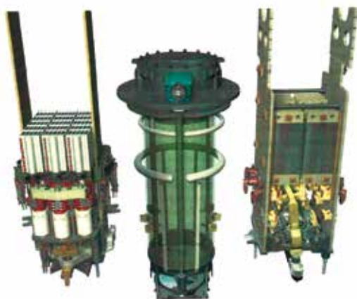
Rys. 5. Rysunek przedstawiający możliwość zamiany tradycyjnego PPZ na próżniowy
