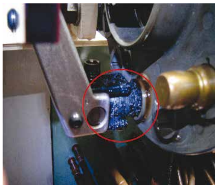
Zdj. 1. Przegrzanie styków zmieniacza przełącznika zaczepów
