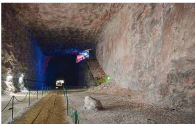
Jedna z ok. tysiąca komór po wydobyciu soli. Wymiary imponujące, bo ok. 15 m wysokości i szerokości i ponad 200 m długości
