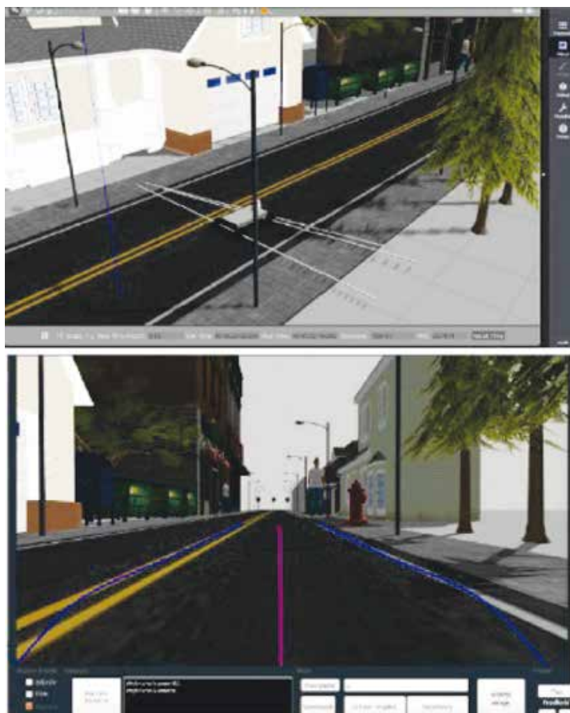
Rys. 1. Zastosowanie algorytmu detekcji krawędzi do sterowania modelem kołowego robota mobilnego
