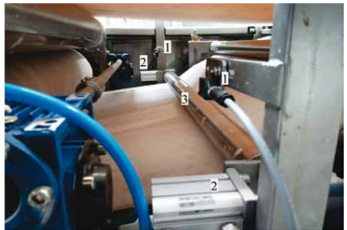
Rys. 3. System prowadzenia taśmy
