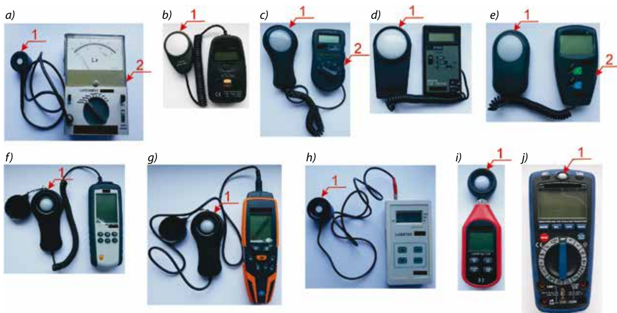
Rys. 1. Zdjęcia przykładowych luksomierzy: a) miernik analogowy, b) – j) mierniki cyfrowe, 1 – głowica fotometryczna, 2 – miernik prądu (rzadziej napięcia) fotoelektrycznego wyskalowany w luksach
