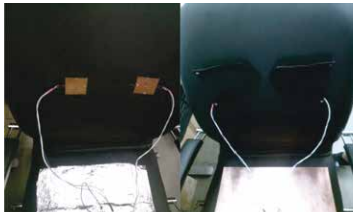
Stanowisko pomiarowe przystosowane do badania wpływu wymiarów i materiału, którego wykonano elektrody referencyjnej oraz liczby warstw izolatora (odzieży)
