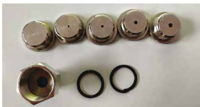
Zasymulowane uszkodzenia instalacji gazowej
